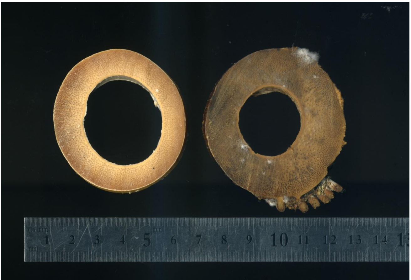
図3 未処理区の竹稈（左）と薬剤処理区の竹稈（右）の横断組織を 25℃、24 時間培養した結果の比較。薬剤処理した組織の表面には多くの微生物増殖が認められます。
