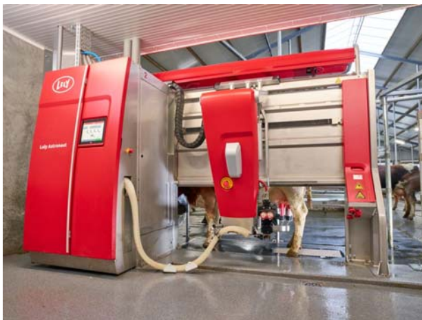
導入が予定されている搾乳ロボット （アストロノート A5 Lely 社製） （全自動で搾乳機を取り付け）
